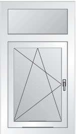
Fenêtre à un vantail avec mécanisme oscillo- battant et imposte fixe ou imposte sous-éclairé
