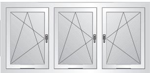
Fenêtre à trois vantaux avec mécanisme oscillo-battant
