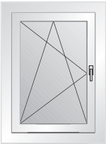
Fenêtre à un vantail avec mécanisme oscillo- battant
