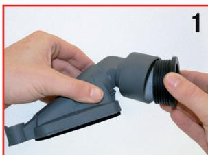
Den beiliegenden Gummadapter in den Ansaugstutzen des **bohrfixx** einschieben.
