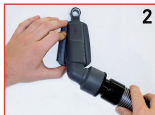
Den Saugschlauch des Staubsaugers an den **bohrfixx** anschließen.
