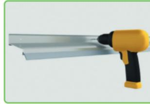
Bohren Sie die Profile unbedingt vor – der Bohrdurchmesser richtet sich dabei nach den verwendeten Schrauben. Die erste Bohrung erfolgt nach 5 cm, alle weiteren dann alle 40 cm.
