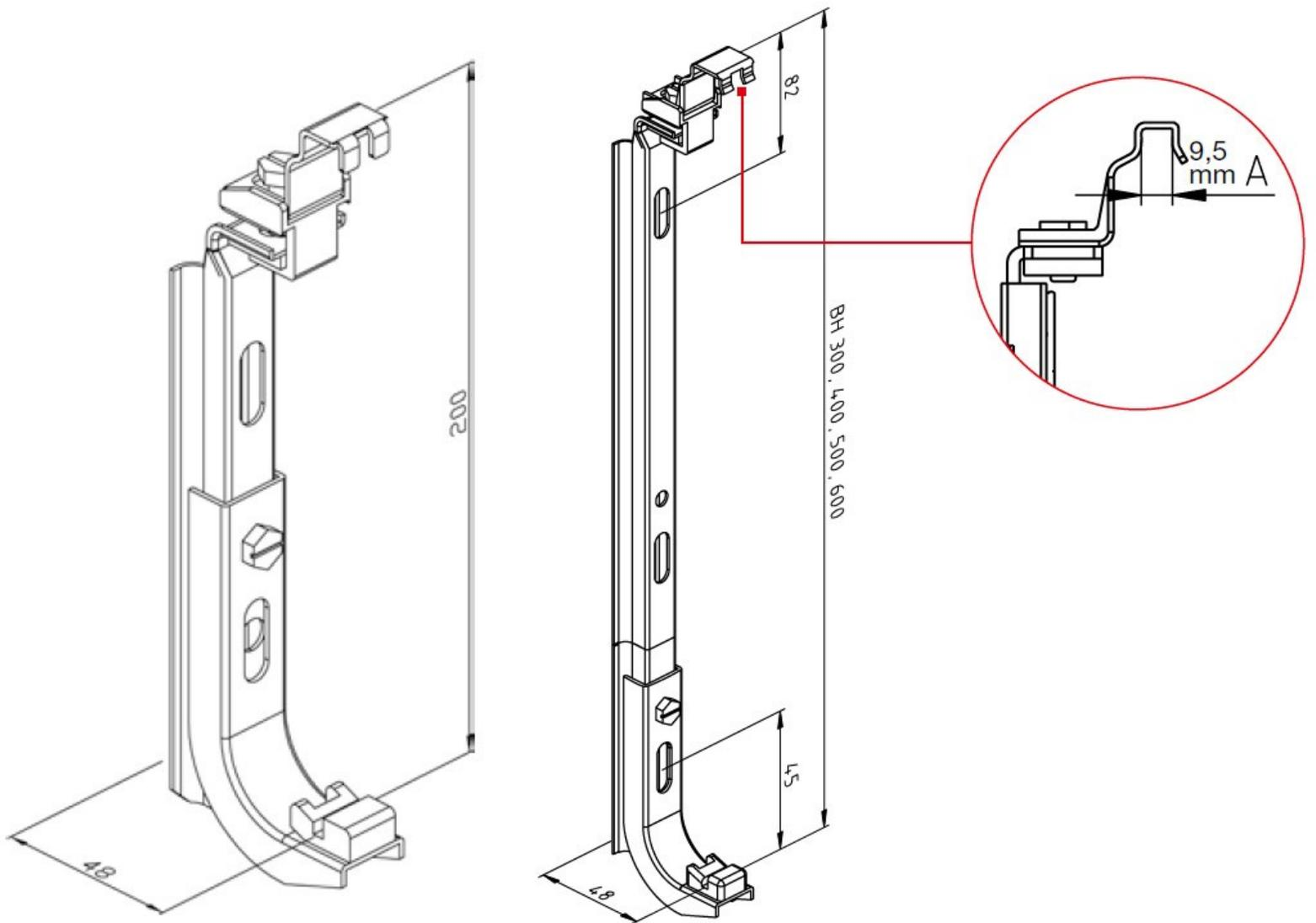
Satz 10-396600 besteht aus 2 Konsolen, 2 Schrauben (8 x 60 mm) und 2 Dübeln (10 mm)
