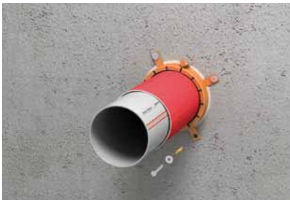
Andübeln der Haltelasche mit dem mitgelieferten Befestigungsset (optional dürfen die Laschen auch 90° umgebogen und eingemörtelt werden!)
