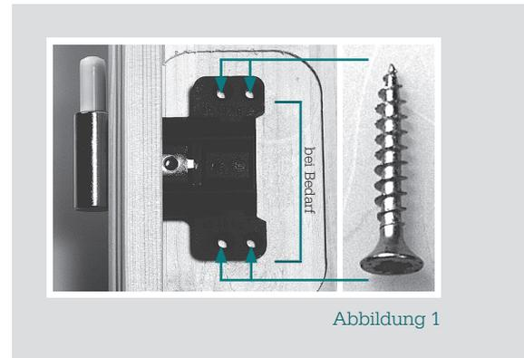
Zusätzlich zur 4-fachen Verschraubung der Bandtasche ist ein spezielles Bandunterteil zwingend notwendig. Dieses Bandunterteil (s. Abbildung B/Art.Nr. 5973813) ist aufgrund seines längeren Aufnahmehakens wesentlich stabiler und gewährleistet eine problemlose Kombination von Holzargen mit schweren Türen.
