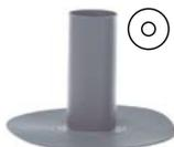
Geschlossenes Rundformstück aus PVC-KDB zur Bearbeitung der Durchführungen. Der Typ bezeichnet den Innendurchmesser des Formteils in mm. Höhe der Manschette 150 mm. Material: trägerlose Dichtungsbahn aus PVC mit 1,5 mm Stärke. Farbgebung hellgrau, etwa RAL 7047.
