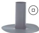
Geschlossenes vierkantiges Formstück aus PVC-Kunststoffdichtungsbahn zur Bearbeitung der Durchführungen. Der Typ bezeichnet den Innenabmessungen des Formteils in mm. Höhe der Manschette 150 mm. Material: trägerlose Dichtungsbahn aus PVC mit 1,5 mm Stärke. Farbgebung hellgrau, etwa RAL 7047.
