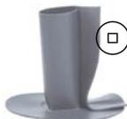
Offenes vierkantiges Formstück aus PVC-Kunststoffdichtungsbahn zur Bearbeitung der Durchführungen. Der Typ bezeichnet den Innenabmessungen des Formteils in mm. Höhe der Manschette 150 mm. Material: trägerlose Dichtungsbahn aus PVC mit 1,5 mm Stärke. Farbgebung hellgrau, etwa RAL 7047.
