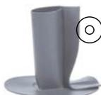
Offenes Rundformstück aus PVC-KDB zur Bearbeitung der Durchführungen. Der Typ bezeichnet den Innendurchmesser des Formteils in mm. Höhe der Manschette 150 mm. Material: trägerlose Dichtungsbahn aus PVC mit 1,5 mm Stärke. Farbgebung hellgrau, etwa RAL 7047.
