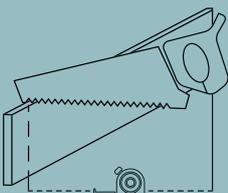
(D) Setzstufen bei Wendelung bauseits anpassen
