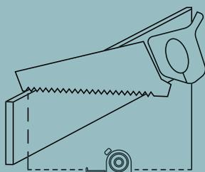
(D) Setzstufen bei Wendelung bauseits anpassen
