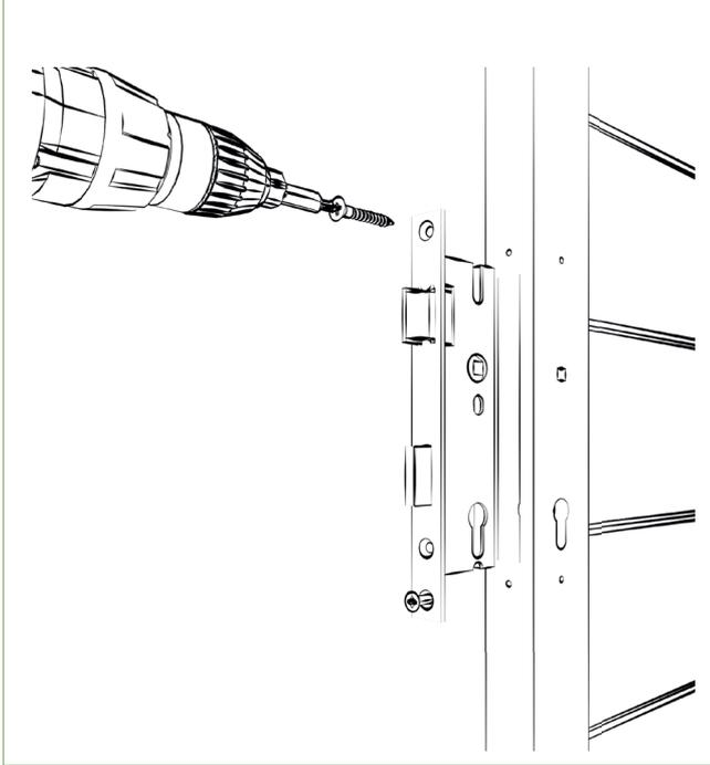
5 | Das Einsteckschloss einsetzen und dessen Position ausrichten, sodass der Schließzylinder und der Griff hineinpassen. Anschließend mit den beigelegten Schrauben befestigen.
