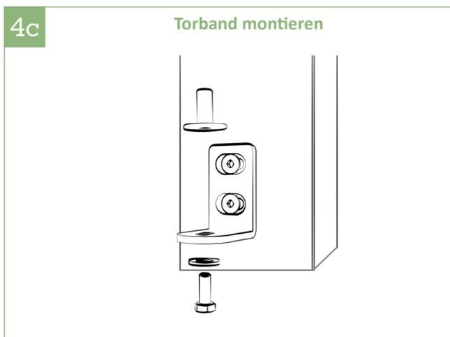
4c | Den unteren Lagerzapfen mit der Sechskantschraube und der Unterlegscheibe an die äußere Position des unteren Torbands schrauben.
