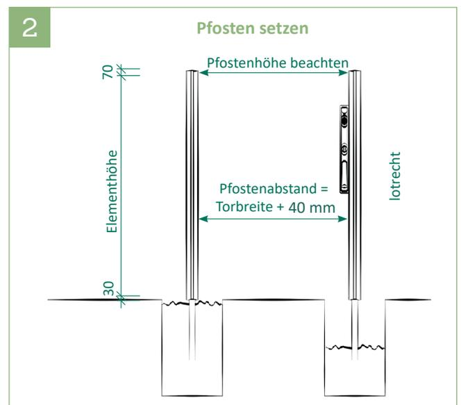
1 | Größe der Fundamente mindestens 500 x 500 x 800mm sowie unter Berücksichtigung der Bodenbeschaffenheit.\* Ungefähr die Hälfte des Erdloches mit Beton füllen und verdichten. Anschließend die Pfosten setzen und ausrichten. Das Erdloch komplett mit Beton füllen und verdichten.
