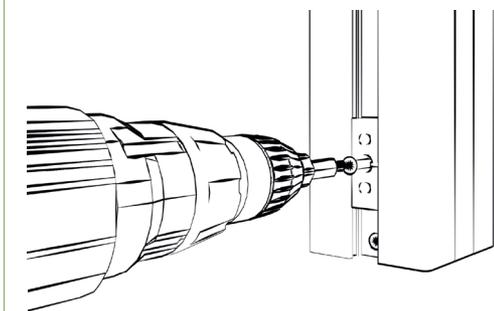
12 | Nutenstein in die Nut des Pfostens einsetzen und bündig mit der unteren Pfostenkante ausrichten. Markierungen für Bohrungen setzen mit 5 mm vorbohren und anhand der Blehschrauben 5,5 x 32 mm montieren.
