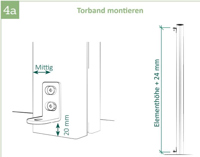
4a | Unteres Torband 20mm vom Boden mittig auf den Pfosten setzen. Pro Loch mit 3mm, danach mit 7mm vorbohren und anschließend mit einem M8 Gewindeschneider nachsetzen, Schrauben eindrehen. Den Abstand zwischen Oberkante des oberen Torbandes und Unterkante des unteren Torbandes ermitteln.
