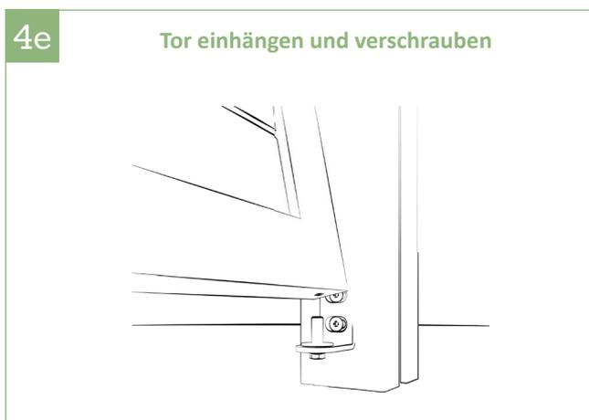
4e | Das Tor auf dem unteren Torlager positionieren.
