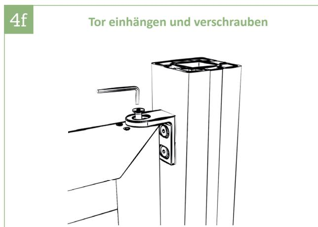
4f | Das Tor ausrichten und den oberen Lagerzapfen mittels Senkschraube befestigen.
