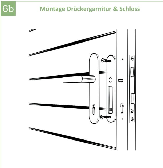
6b | Türdrücker innen einsetzen und anschrauben. Anschließend mit dem Türschild abdecken.
