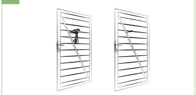
3b | Mit einem 4,5 mm Bohrer durch die erste Wandung der Füllung bohren, dann die Kunststoffdübel vorsichtig bündig einschlagen. Die Diagonalstrebe wieder einsetzen und mit den mitgelieferten Schrauben von Hand befestigen.
