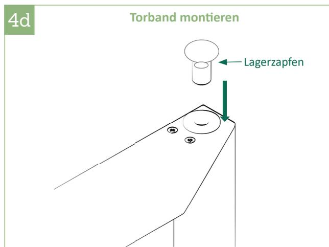
4d | Den oberen Lagerzapfen in das Torlager führen.
