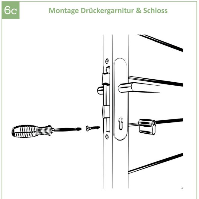
6c | Zylinderschloss einsetzen und die Schraube mit dem Schraubendreher PH2 andrehen.
