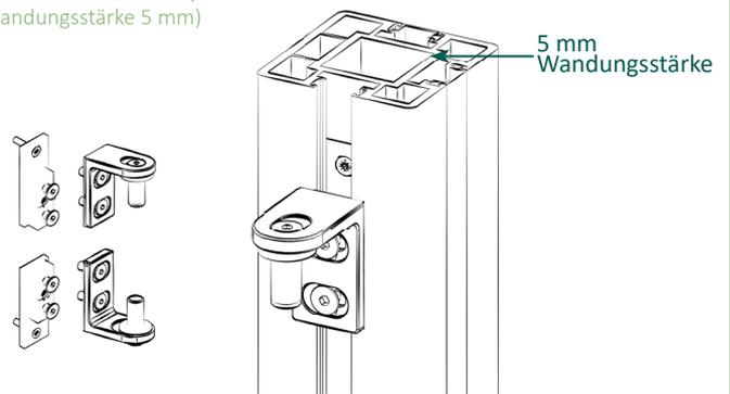
4 | Bei allen stahlverstärkten Torpfosten bitte die Torbänder ohne Nutenstein verwenden. Die Montage erfolgt nur auf der Seite ohne Nut. Bei der Montage des Aluminium Torpfostens mit einer Wandungsstärke von 5mm, die Torbänder mit Nutenstein verwenden und Schritt 12 folgen.
