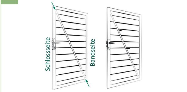
3a | Diagonalstrebe auf der gewünschten Seite des Tores von unten Bandseite, nach oben zur Schlosseite positionieren! Alle drei Löcher anzeichnen und Diagonalstrebe wieder herausnehmen.
