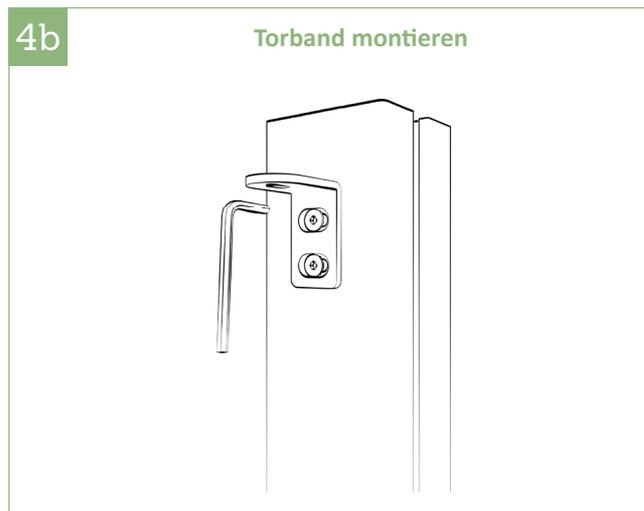
4b | Oberes Torband mit dem ermittelten Abstand vom unteren Torband befestigen. Pro Loch mit 3mm, danach mit 7mm vorbohren und anschließend mit einem M8 Gewindeschneider nachsetzen, Schrauben eindrehen.
