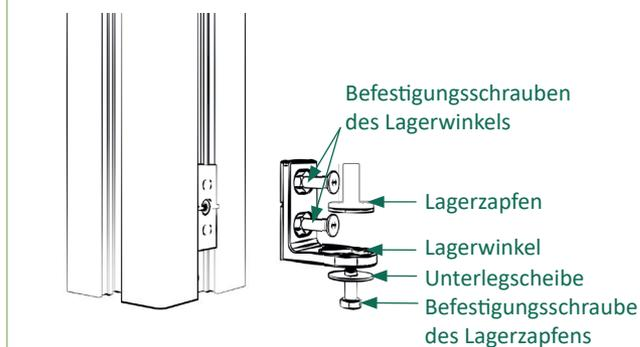
13 | Lagerwinkel mit Senkschrauben M8x25 an den Nutenstein befestigen und mittig ausrichten. Anschließend den Lagerzapfen mit der Sechskantschraube M8x20 und der Unterlegscheibe an den Lagerwinkel befestigen und die äußere Position einstellen.
