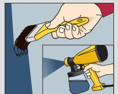
Zum dauerhaften Betonschutz: Zaun mit Beckers Betonzaunfarbe behandeln. Farbe gut aufrühren und mit max. 10% Wasser verdünnen. Ergiebigkeit beträgt je nach Oberfläche und Struktur ca. 0,4 Liter/m<sup>2</sup>.
