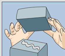
Pfostenkappen und Oberlatten mit Flexkleber montieren. Zum Abschluss des Rohbaus Zaunelemente reinigen.
