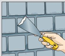
Für ein einheitliches Bild: Motivplatten mit Hebel ausrichten. Kleinere Abplatzer, „Schürfwunden“ und Haarrisse mit Spachtelmasse ausbessern.
