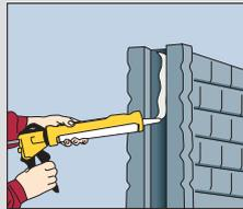
Acrylnaht in die Pfostennut einbringen.
