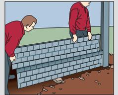
Motivplatten entsprechend der passenden Seite in die Pfostennut einsetzen und weiter verkleben.
