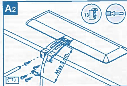
Sistema de enganche sobre espejo / Attachment to mirror / Système d'accrochage sur miroir / Крепление на зеркало
