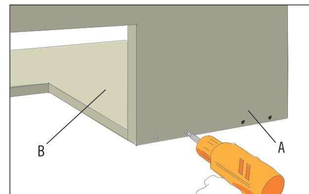
L'élément de base (A) comporte des trous de perçage par lesquels il est vissé à l'élément latéral (B). Bascule la construction vers l'arrière pour la visser. Utilise ici des vis à bois de 3 x 25 mm.
