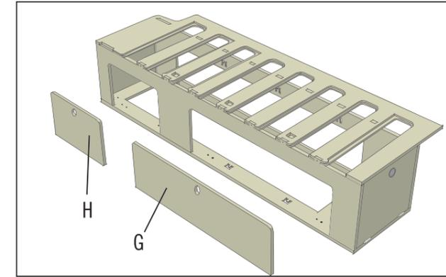
Les deux clapets frontaux (G) et (H) se fixent sur le corps du meuble de la même manière que les deux clapets de façade.
