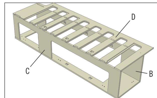
L'élément de sommier (D) est mis en place par le haut. Les tenons sur le bord supérieur des éléments latéraux (B) et (C) s'insèrent exactement dans les fraisages de l'élément de sommier. Des trous de perçage se trouvent à côté des tenons. Visse les éléments à l'aide de vis à bois de 3 x 25 mm.
