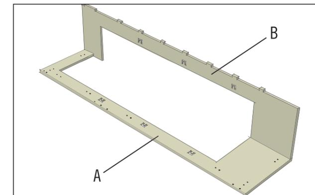
L'élément latéral (B) repose sur le bord arrière de l'élément de base (A). Dans la partie inférieure de la plus petite des deux pattes verticales se trouve une marche qui rentre exactement dans l'élément de base.
