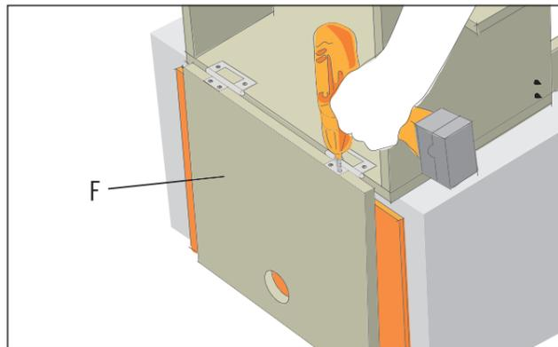
Pour pouvoir visser facilement le clapet (F) sur les charnières de porte à lamelles, tu peux construire une structure auxiliaire en bois ou en carton. Tu peux ainsi soulever le corps et visser les clapets de façade (F) sur leurs côtés étroits avec les charnières. Utilise pour cela des vis à bois à tête fraisée de 3 x 16 mm. Pour maintenir le bon écart, il est recommandé de coincer une petite planche de
