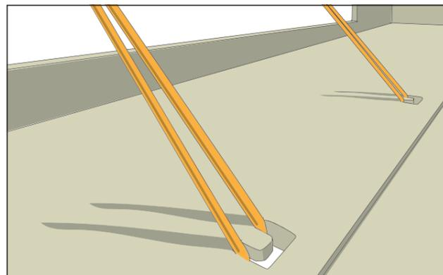
Dans l'espace de rangement, des encoches ont été fraisées à plusieurs endroits dans les éléments du panneau, sur lesquelles des bandes extensibles peuvent être fixées. Cela permet de fixer les ustensiles à l'intérieur de l'espace de rangement.
