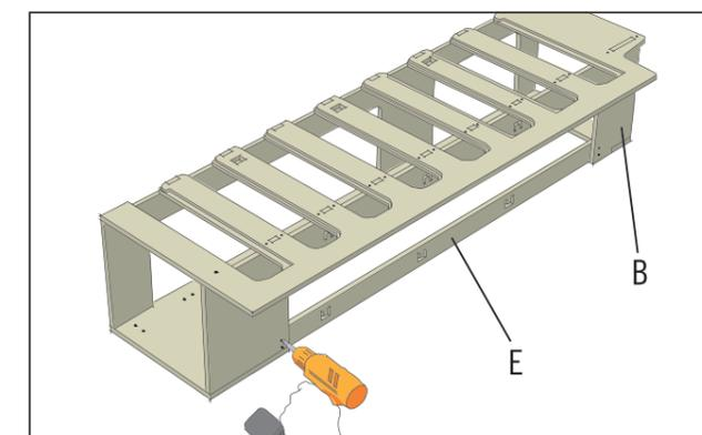
Introduis la traverse (E) entre les deux pattes verticales de l'élément latéral (B) par l'intérieur et visse-la avec des vis à bois de 3 x 25 mm par l'extérieur.
