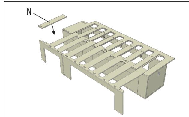
Lorsque le sommier est déployé, la pièce d'arrêt (N) est mise en place pour stabiliser la construction. Celle-ci peut être fixée en option sur le corps du meuble à l'aide d'un ruban auto-agrippant afin de l'avoir à portée de main en cas de besoin.
