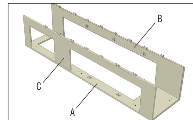
Visse l'élément latéral (C) parallèlement à (B) sur l'élément de base (A) avec des vis à bois de 3 x 25 mm. Bascule la construction vers l'avant et soutiens l'élément latéral (B) pendant le vissage de (C).
