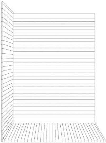
(3) Setzen Sie die linke Seitenwand an die Bodenplatte und verbinden Sie sie mit der Rückwand
