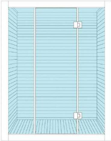
(4) Setzen Sie die Frontplatte neben die linke und rechte Wand und verbinden Sie sie.
