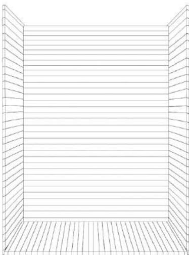
(4) Setzen Sie die rechte Seitenwand an die Bodenplatte und verbinden Sie sie mit der Rückwand
