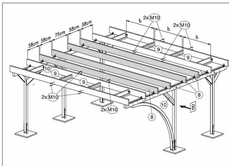
616.5050.40: Die Kopfbänder an den Mittelpfosten werden in Längsrichtung angebracht
