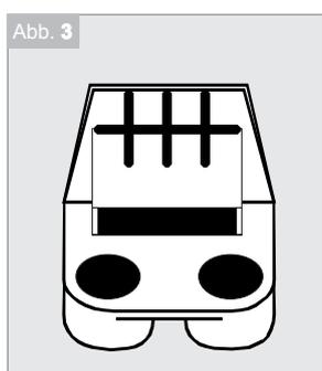
Mit der beiliegenden Bohrerschablone (Abb. 3) werden die notwendigen Bohrungen für die Bandunterteile eingebracht. Die Schablone am Aufrechtteil anlegen und an der Klemmnussfräsung fixieren. Mit einem  $\varnothing 7,5$  mm Bohrer die Bohrungen ca. 42 mm tief einbringen.
