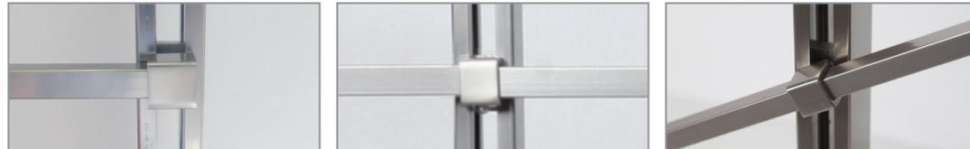
Die Vierkantstäbe können im Halter gestoßen werden. In der Mitte des Halters die Stäbe stoßen und dann mit der Schraube von unten fixieren.
