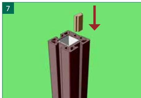
7 | Même si les profilés peuvent être placés directement au sol, nous vous recommandons de visser une baguette rainurée d'env. 3 cm de long dans les rainures de réception. Celles-ci servent d'entretoises au-dessous du profilé de remplissage inférieur. Dans ce cas, la planche de profilé inférieure doit être étayée au milieu afin d'éviter qu'elle ne ploie.
