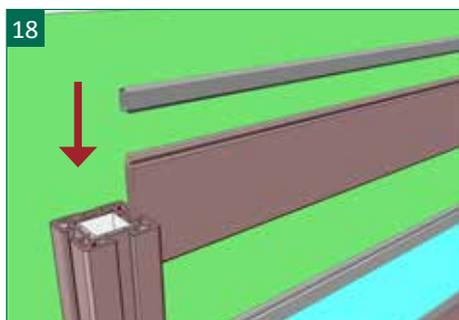
18 | Mettre enfin en place le profilé de remplissage supérieur, ainsi que le profilé de finition en aluminium. Pour des raisons de stabilité, un profilé de remplissage doit toujours être prévu au-dessus d'un élément de conception !
