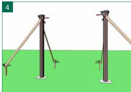
4 | Remplir les trous dans le sol humide de béton préparé ou de chape de béton. Comprimer le béton avec une cale en bois ! Pendant toute la procédure, vérifier que les poteaux restent en bon état ! Pour finir, éliminer à l'eau les résidus de béton des poteaux ! Laisser le béton durcir d'après les indications sur l'emballage (au moins 24 heures). Caler les poteaux jusqu'au durcissement du béton.
