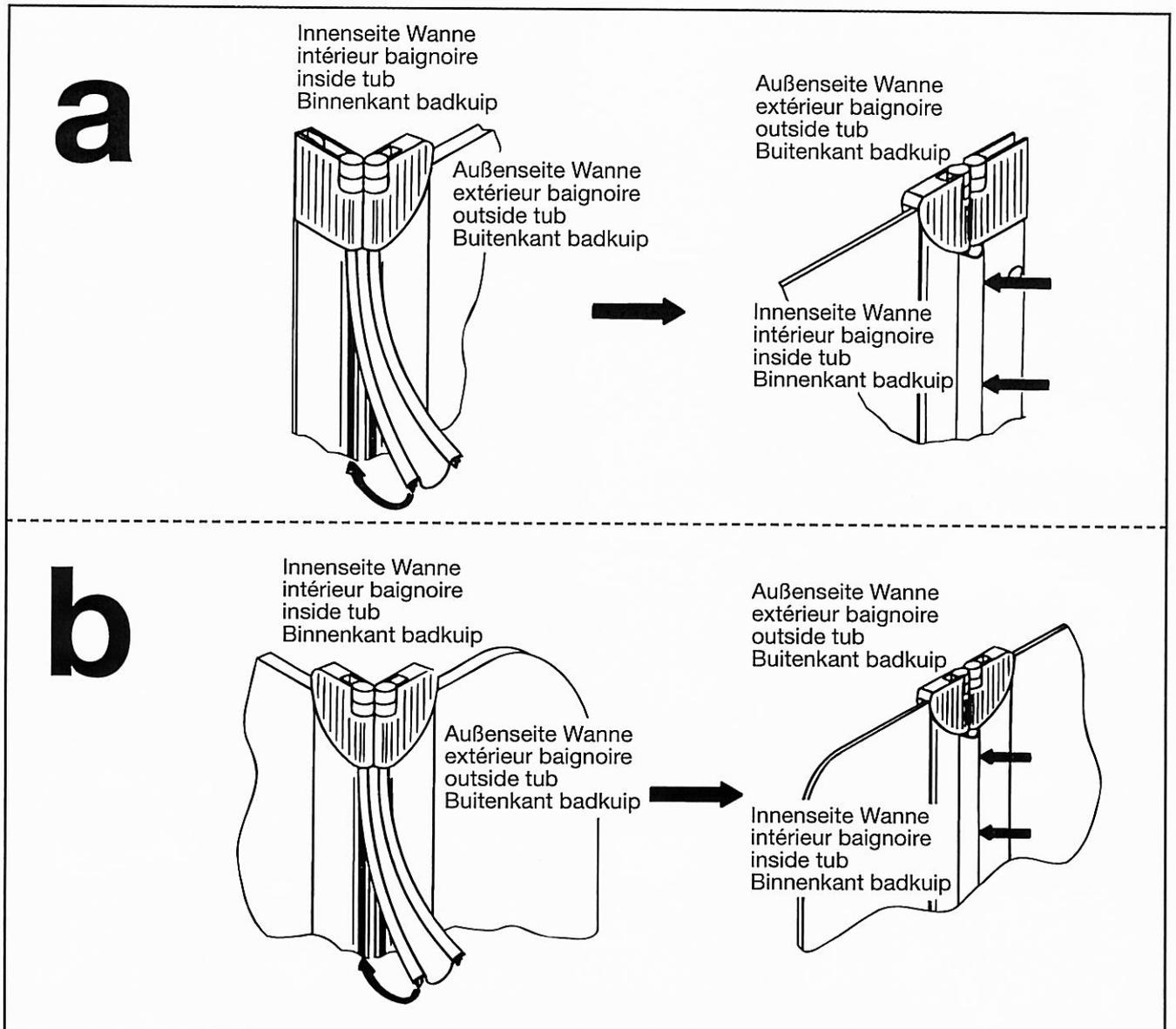
Scharnierdichtprofil durch Daumendruck, an einem Ende beginnend, in die Nuten der senkrechten Aluminiumprofile einclippen. Die Wölbung der Weichlippe zwischen den Profilen muß unbedingt zur Wanneninnenseite gerichtet sein.
