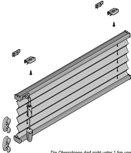
Die Oberschiene darf nicht unter 1,5m vom Fußboden aus montiert werden. Schnurwickler müssen so nah wie möglich an der Oberschiene befestigt werden, in allen Fällen jedoch über 1,5m vom Fußboden aus entfernt.
