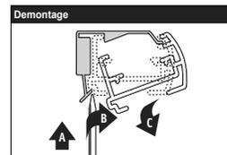
! \* Heben Sie die Unterschiene nicht höher als die Mittelschiene um eine Schlaufe, an der man sich strangulieren kann, zu vermeiden.
