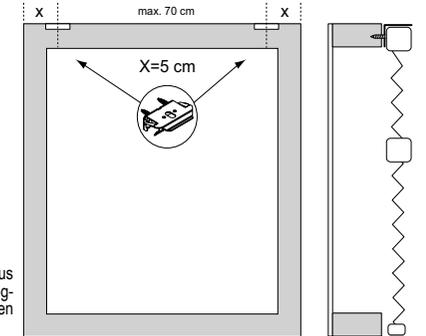
Die Oberschiene darf nicht unter 1,5m vom Fußboden aus montiert werden. Schnurwickler müssen so nah wie möglich an der Oberschiene befestigt werden, in allen Fällen jedoch über 1,5m vom Fußboden aus entfernt.
