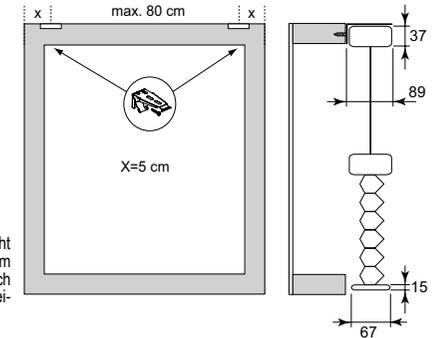
! \* Heben Sie die Unterschiene nicht höher als die Mittelschiene um eine Schlaufe, an der man sich strangulieren kann, zu vermeiden.
