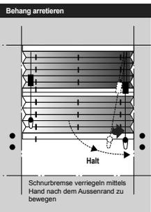
! \* Heben Sie die Unterschiene nicht höher als die Mittelschiene um eine Schlaufe, an der man sich strangulieren kann, zu vermeiden.
