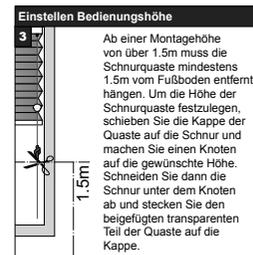
Ab einer Montagehöhe von über 1.5m muss die Schnurquaste mindestens 1.5m vom Fußboden entfernt hängen. Um die Höhe der Schnurquaste festzulegen, schieben Sie die Kappe der Quaste auf die Schnur und machen Sie einen Knoten auf die gewünschte Höhe. Schneiden Sie dann die Schnur unter dem Knoten ab und stecken Sie den beigefügten transparenten Teil der Quaste auf die Kappe.
