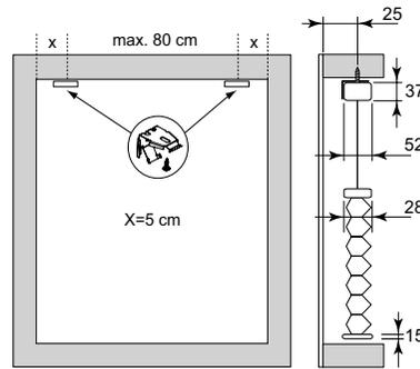
! \* Heben Sie die Unterschiene nicht höher als die Mittelschiene um eine Schlaufe, an der man sich strangulieren kann, zu vermeiden.
