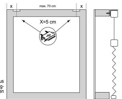
Die Oberschiene darf nicht unter 1,5m vom Fußboden aus montiert werden. Schnurwickler müssen so nah wie möglich an der Oberschiene befestigt werden, in allen Fällen jedoch über 1,5m vom Fußboden aus entfernt.
