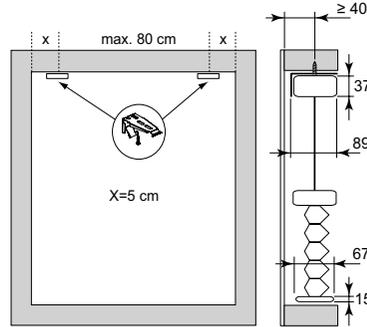
! \* Heben Sie die Unterschiene nicht höher als die Mittelschiene um eine Schlaufe, an der man sich strangulieren kann, zu vermeiden.
