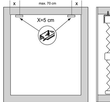
Die Oberschiene darf nicht unter 1,5m vom Fußboden aus montiert werden. Schnurwickler müssen so nah wie möglich an der Oberschiene befestigt werden, in allen Fällen jedoch über 1,5m vom Fußboden aus entfernt.
