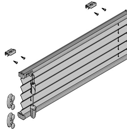
Die Oberschiene darf nicht unter 1,5m vom Fußboden aus montiert werden. Schnurwickler müssen so nah wie möglich an der Oberschiene befestigt werden, in allen Fällen jedoch über 1,5m vom Fußboden aus entfernt.
