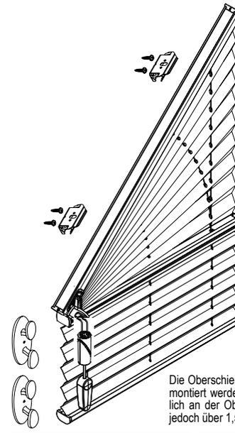
Die Oberschiene darf nicht unter 1,5m vom Fußboden aus montiert werden. Schnurwickler müssen so nah wie möglich an der Oberschiene befestigt werden, in allen Fällen jedoch über 1,5m vom Fußboden aus entfernt.
