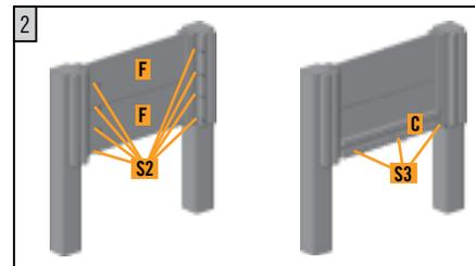
Jeweils 2 Seitenbretter **E** oben bündig in die Nutleisten einführen und mit **S2** verschrauben. Anschließend die Pfosten mit der einen Nutleiste ansetzen und montieren (alles vorbohren).
