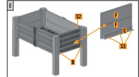
Die Rahmenbretter **H** und **I** vorbohren, auf dem Untergestell ausrichten und mit **S2** fixieren.
