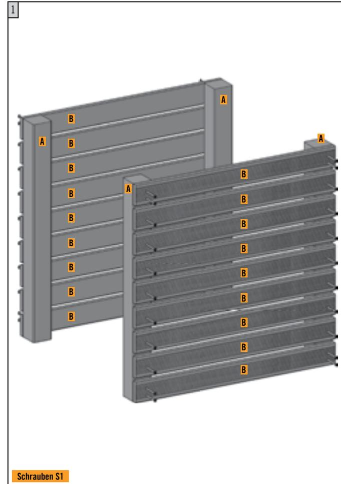
Nun können die beiden Seitenteile mit den restlichen Brettern **B** verbunden werden. Dazu werden jeweils 8 Stück mit der Oberkante auf der Höhe der Mitte der schon montierten Bretter an den Seitenteilen ausgerichtet und an die Pfosten **A** geschraubt (die äußeren Bretter wieder doppelt verschrauben).
