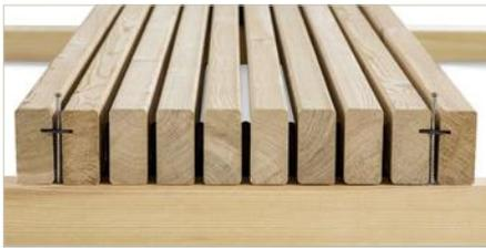
Wir empfehlen, jedes Element mindestens an den vier Ecken mit der Unterkonstruktion zu verschrauben. Hierzu schieben Sie bitte die mitgelieferten schwarzen Beilagscheiben in die Nuten der zwei äußeren Lamellen. Jetzt können Sie wahlweise mit Fassadenschrauben 4,5 x 70 mm oder Terrassenschrauben 5 x 70 mm die Befestigung vornehmen.
