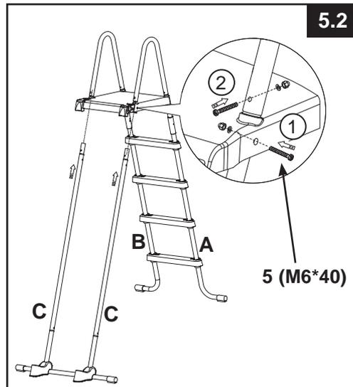
**IMPORTANT :** Un côté à la fois. Ne pas attacher l'autre côté de l'échelle avant que la structure en U supérieure ne soit installée. Ne bloquez pas les vis avant d'avoir effectué la dernière opération de montage.
