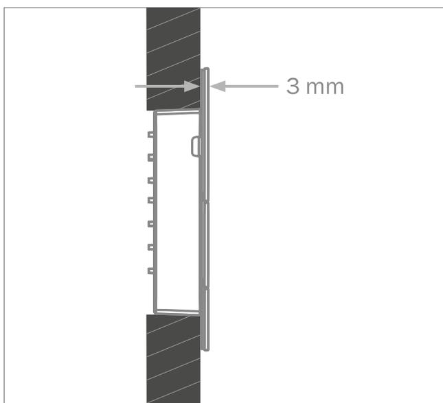
TECEsquare II mit extraflachem Aufbau und integriertem Einbaurahmen.
