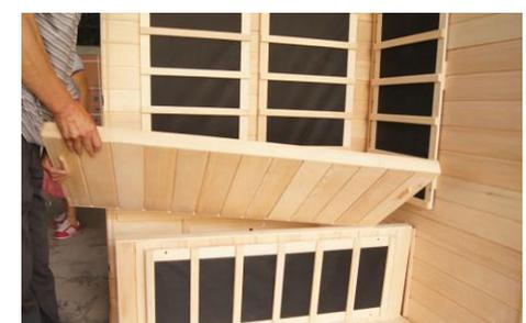
Stellen Sie sicher, dass der „BACK“ Sticker nach hinten an das hintere Paneel zeigt, die glatten und fertigen Seiten des Sitzpaneels nach oben und vorne zeigen.
