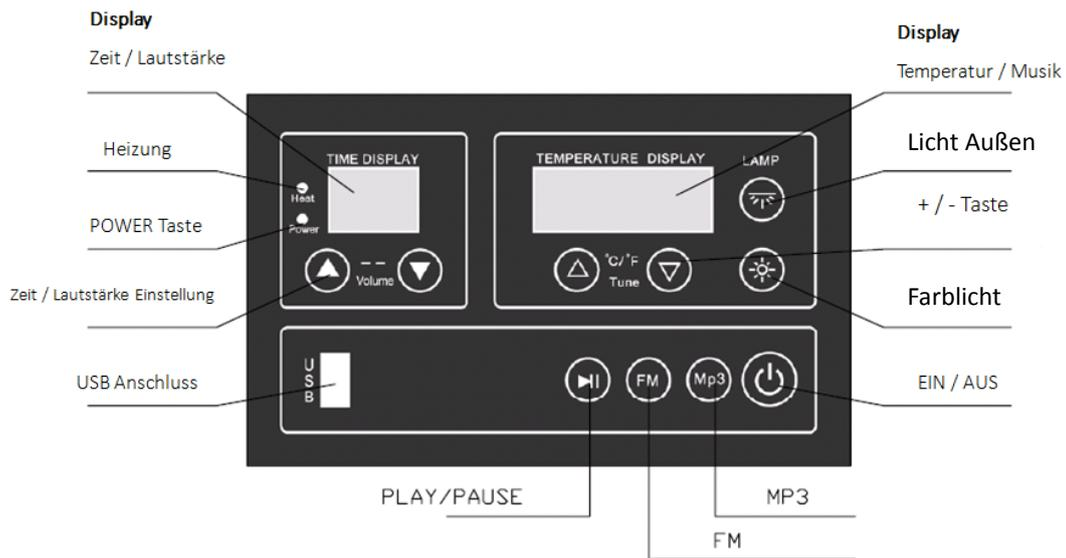
1. Drücken Sie die EIN/AUS Taste, um die Kabine einzuschalten. Das Licht bei der Power-Status-Anzeige schaltet sich ein.
