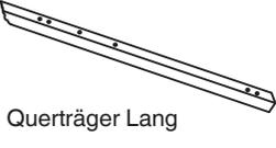
Querträger Lang<br>2020mm mit Laufschiene    | 2    | 3    | 13  |
