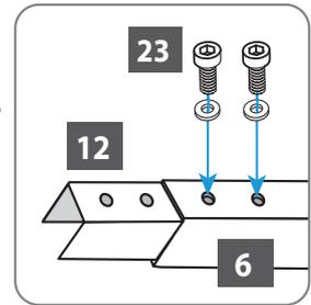
Schieben Sie den Querträger Lang mit Laufschiene (6) durch den Verbinder Pfosten (15) und fixieren Sie diesen mit den Schrauben (23).
