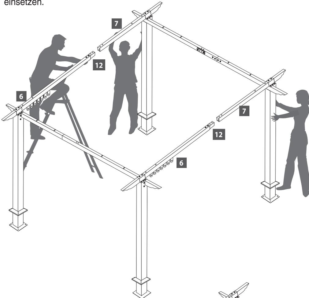
Stellen Sie sicher, dass die Pergola in der Waage steht und verschrauben Sie den Verbinder (12) mit den Schrauben (23)
