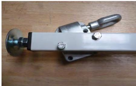
3. Setzen Sie nun die Gummiteller auf die Höhenversteller. Durch die vorgestanzten Löcher der Versteller, bohren Sie mit einem Bohrer  $\text{\O} 4 \text{ mm}$ , jeweils 1 Loch durch die Gummiteller (oben). Dies dient zur späteren Verschraubung am Balkon. Nun richten Sie die Klemmstützen mit Hilfe einer Wasserwaage aus und verspannen Die Stützen mittels der Stellschraube zwischen Balkonboden und Balkondecke.
