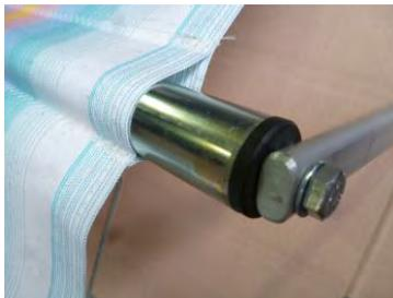
7. Nun das Markisentuch wieder aufkurbeln. Verbinden Sie die Arme mit den Klemmstützen. Hierfür wird jeweils eine Sechskantschraube M8 x 55, zwei U-Scheiben 8,4 und eine Polyamidscheibe 8,4.
