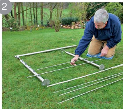
2 Insérez les barreaux dans les supports barreaux
