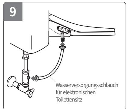
9 Verbinden Sie den flexiblen Schlauch von der Seite des T-Ventils mit dem Gerät. Drehen Sie das Wasserventil nach links, um den Wasserfluss zu starten.
