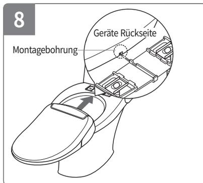
8 Nachdem die Montageplatte nun auf der Toilette befestigt ist, schieben Sie das Gerät mittig mit der Montagebohrung auf die Montageplatte bis Sie ein „click“ hören und das Gerät eingerastet ist.
