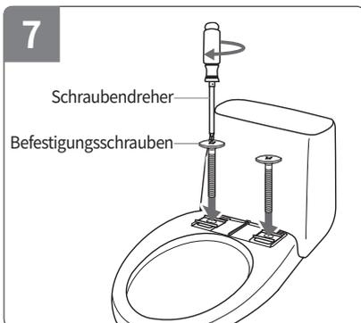
7 Stecken Sie die Befestigungsschrauben durch die Halterungen in die Gummipropfen mit Gewinde und drehen Sie die Schrauben mit einem Schraubendreher fest an.
