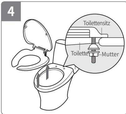
4 Lösen Sie die Muttern auf beiden Seiten des vorhandenen WCSitzes, um Sitz und Deckel zu entfernen.
