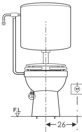
Für die Situation Wasseranschluss links ist im Lieferumfang ein Anschluss-Set enthalten
