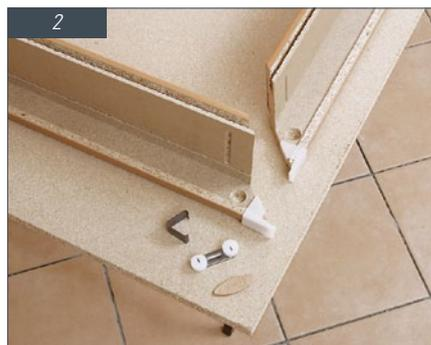
Die Zargenelemente werden durch Stahlklammern (links) und Doppelexzenter (Mitte) sowie Flachdübel aus Holz verbunden.
