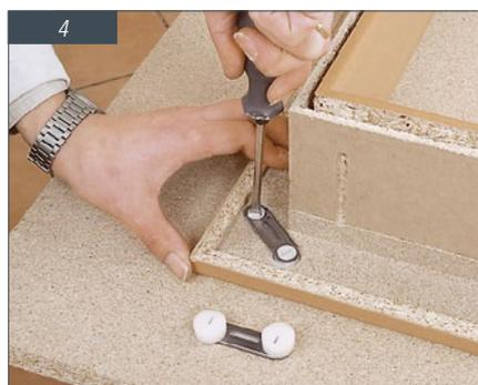
Die runden Kunststoffpropfen des Doppelexzenter drücken Sie in die Bohrungen auf der Zargenrückseite und ziehen die Schrauben fest.
