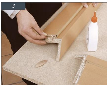
Stecken Sie den Flachdübel in den vorgesehenen Schlitz des Zargenelements. Tragen Sie nun den Leim auf und setzen Sie die Elemente zusammen.
