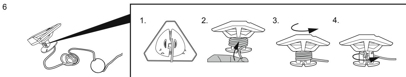
**Uwaga:** Podważyć, aby odłączyć pokrywę pływaka, zwolnić linię z pływaka do głębokości wody basenowej plus około 0,5 m (19,7").
