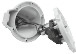
3. Remova a bateria para expor o PCBA. Para prender o cabo de ligação da bateria, prima o gancho no conector e puxe para fora. **NOTA:** Envolva o conector imediatamente com fita isoladora de forma a evitar curto-círcito provocado pelo contacto de ambos os terminais do fio.
