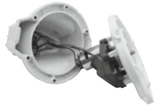
3. Verwijder de batterij om bij de printplaat te kunnen komen. Druk op de clip op de connector en trek die dan naar buiten om de verbindingsdraad van de batterij los te maken. **OPMERKING:** Omwikkel de pool onmiddellijk met isolatietape om kortsluiting door contact tussen de beide polen te voorkomen.
