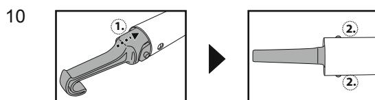
**Obs:** Om flölet är för långt bort för att nås med handen, använd den medföljande kroken. Placera kroken på den utdragbara stången (medföljer ej) och använd sedan kroken för att fånga flölet.
