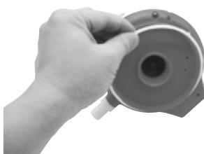
2. С помощью отвертки открутите 4 винта, расположенные на дне головки, чтобы снять сначала нижнюю пластину. С помощью отвертки открутите все винты на основании, как показано. Извлеките крыльчатку, а затем подденьте и снимите основание, чтобы открыть доступ к внутренней полости головки.
