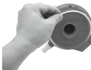
2. Con un cacciavite rimuovere le 4 viti nella parte inferiore della testina, in modo da smontare la piastra alla base. Svitare col cacciavite tutte le viti della base come indicato in figura. Rimuovere la girante, fare leva sulla piastra e rimuoverla, quindi scoprire l'interno.
