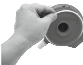
2. Utilize uma chave de parafusos para desaparafusar os 4 parafusos que se encontram no fundo da cabeça para soltar primeiro a placa do fundo. Utilize a chave de parafusos para desaparafusar todos os parafusos na base conforme ilustrado. Remova o impulsor e levante a base e remova-a para expor a cabeça no seu interior.
