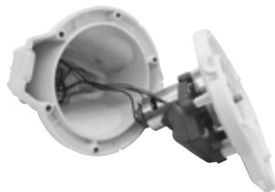
3. Retirez le bloc batterie pour exposer l'assemblage de cartes de circuits imprimés. Pour détacher le câble de connexion de la batterie, appuyez sur le clip sur le connecteur et retirez-le. **REMARQUE :** Enroulez immédiatement le connecteur avec du ruban isolant afin d'éviter tout court-circuit dû au contact des deux fils.
