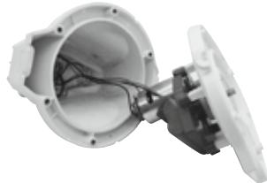
3. Wymontować pakiet akumulatorowy, aby odsłonić PCBA. Aby odłączyć przewód łączący akumulator, nacisnąć zacisk na złączu, a następnie wyciągnąć go. **UWAGA:** Natychmiast owinąć złącze taśmą izolacyjną z celu uniknięcia zwarcia spowodowanego przez kontakt między obiema końcówkami przewodów.
