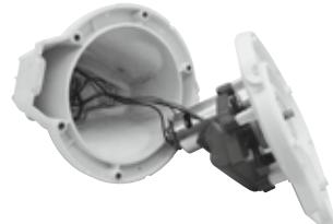
3. Irrota akkuyksikkö. Piirilevy tulee näkyviin. Irrota akun liitinjohto painamalla liittimen klipsiä ja nostamalla akku sitten pois. **HUOMAA:** Kierrä liittimen päähän eristysteippiä, jotta kummankin liittimen koskettaminen ei aiheuta oikosulkua.
