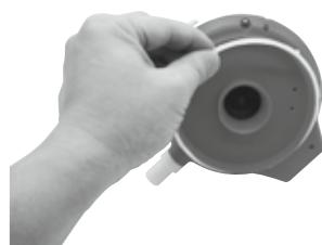
2. Lösen Sie vier (4) Schrauben am Boden des Kopfes mit einem Schraubendreher, um zuerst die Bodenplatte abzunehmen. Lösen Sie alle Schrauben, wie abgebildet, mit einem Schraubendreher. Nehmen Sie das Schwungrad heraus, heben Sie den Sockel frei und nehmen Sie ihn heraus, um das Innere des Kopfes freizulegen.
