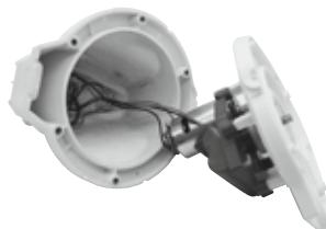
3. Estrarre la batteria per localizzare il circuito stampato. Scollegare il cavo batteria premendo sulla clip del connettore e tirando verso l'esterno. **NOTA:** Avvolgere i connettori con nastro isolante per evitare corti circuiti causati dal contatto tra entrambi i terminali.
