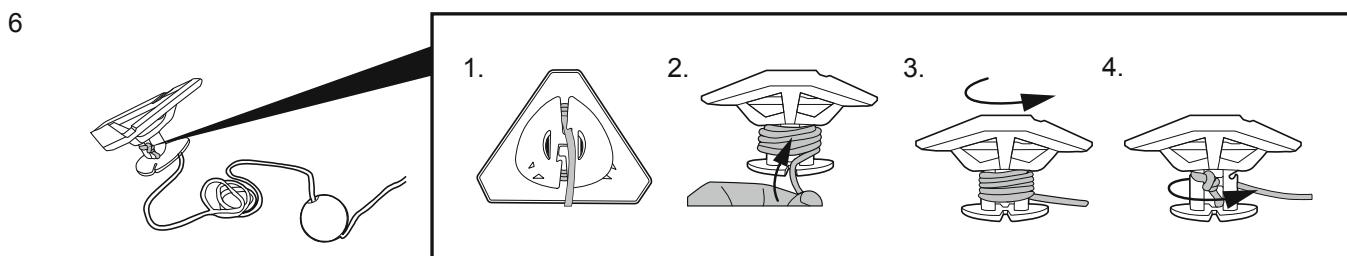
**Hinweis:** Nehmen Sie die Schwimmerabdeckung ab und lassen Sie das Schwimmerseil bis zur Tiefe des Poolwassers ab, plus circa 0,5 m (19.7in.).
