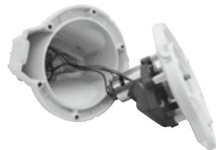
3. Távolítsa el az akkumulátorcsomagot a nyomtatott áramköri lap felfedéséhez. Az akkumulátor csatlakozókábelének a leválasztásához nyomja le a csatlakozón található kengyelt, és húzza ki a csatlakozót. **MEGJEGYZÉS:** A csatlakozót azonnal tekerje be szigetelőszalaggal, hogy megelőzze az egyéb kábelcsatlakozókkal való esetleges érintkezés okozta rövidzárlatot.
