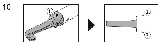
**Hinweis:** Wenn der Schwimmer zu weit entfernt ist, um ihn mit der Hand herauszunehmen, verwenden Sie bitte den beiliegenden Haken. Befestigen Sie den Haken an der Teleskopstange (nicht enthalten) und verwenden Sie den Haken dann, um den Schwimmer herauszunehmen.
