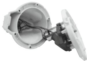
3. Извлеките батарейный блок, чтобы получить доступ к электронному блоку на печатной плате. Чтобы отсоединить соединительный провод батареи, нажмите язычок пружинного коннектора и вытяните провод. **ПРИМЕЧАНИЕ.** Немедленно оберните коннектор изоляционной лентой во избежание короткого замыкания вследствие контакта двух клемм.
