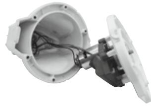
3. Nehmen Sie den Akkusatz heraus, um die Leiterplatte freizulegen. Um das Akkuanschlusskabel zu lösen, drücken Sie die Klammer am Steckverbinder und ziehen es heraus. **HINWEIS:** Wickeln Sie sofort Isolierband um den Steckverbinder, damit ein Kurzschluss infolge des Kontakts der beiden Drähte verhindert wird.
