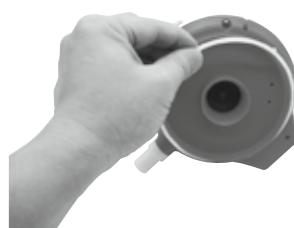
2. Użyć wkrętaka do odkręcenia 4 wkrętów znajdujących się w dolnej części głowicy, aby najpierw zwolnić płytę dolną. Użyć wkrętaka do odkręcenia wszystkich wkrętów podstawy, tak jak pokazano. Wymontować wirnik, a następnie podważyć podstawę i zdjąć ją, aby odsłonić wnętrze głowicy.
