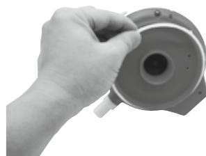
2. Use el destornillador para aflojar los 4 tornillos presentes en la parte inferior del cabezal, para soltar en primer lugar la placa inferior. Use el destornillador para aflojar todos los tornillos de la base, como se ve en la figura. Retire el impulsor y luego haga palanca en la base y retírela para dejar a la vista el interior del cabezal.
