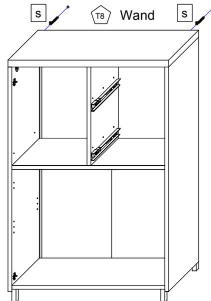
T9 Lassen Sie den Schrank nur durch fachkundige Personen mit für die Wand geeigneten Montagematerialien montieren.
