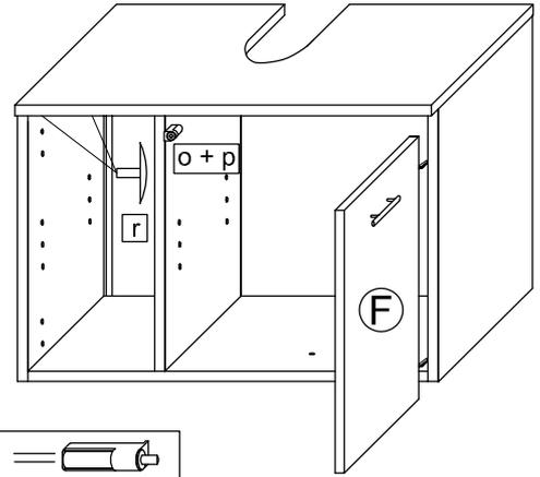
T11 Bei Türmontage das Scharnier einhängen, bis Anschlag öffnen und anschließend festschrauben.
