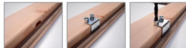
Le gabarit de perçage est nécessaire au perçage des trous pour les gonds. Placer celui-ci dans le trou prévu pour la noix de serrage. Percer les trous avec une mèche de  $\varnothing$  7,5 mm à une profondeur d'environ 42 mm.
