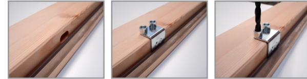
Bringen Sie die Schablone am Seitenteil an und fixieren Sie diese an der Klemmnussfräsung. Bohren Sie mit einem ø 7,5 mm Bohrer die Bohrungen ca. 42 mm tief.
