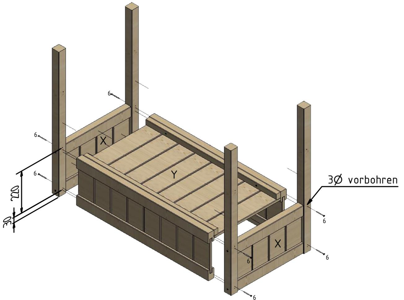
Die Kopfteile (X) mit Boden und Seiten (Y) verbinden
