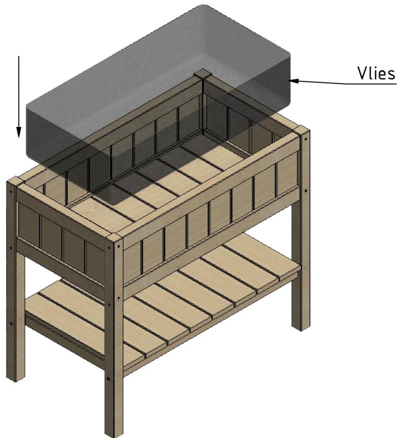
Vlies (9) passend zuschneiden und einsetzen ggf. vor dem Befüllen mit Erde zusätzlich mit Klammern heften (Heftklammern sind nicht im Lieferumfang enthalten)
