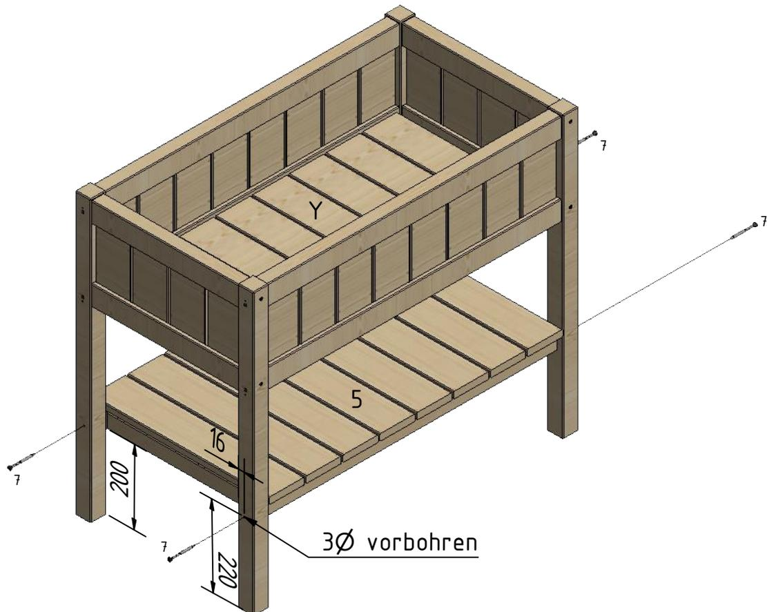
In den Korpus (Y) den Zwischenboden (5) einbringen u. verschrauben.
