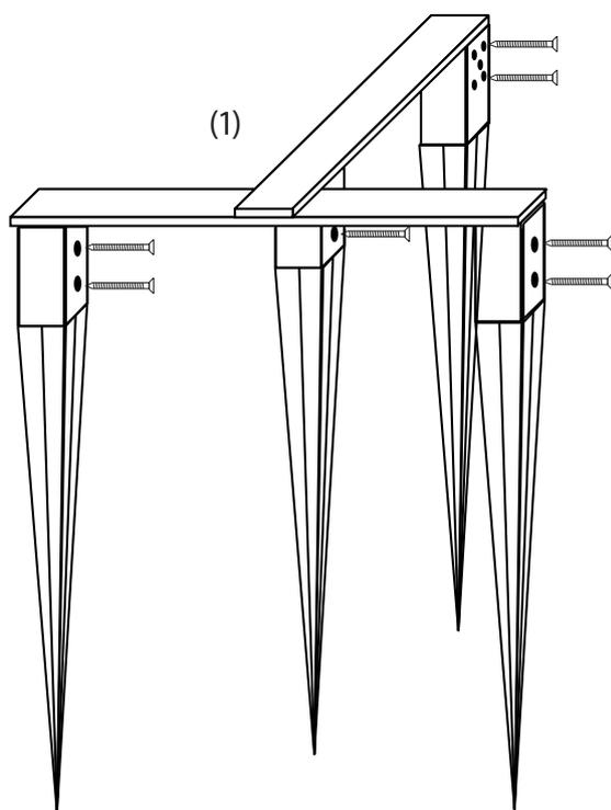
Utilisez le gabarit pour déterminer la position des trous Béton dans les prises de terre à impact.
