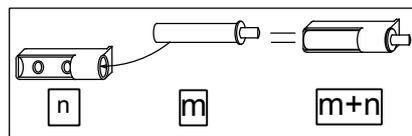
**T11** Bei Türmontage das Scharnier einhängen, bis Anschlag öffnen und anschließend festschrauben.
