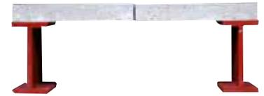
Betonboden auf Stahl
