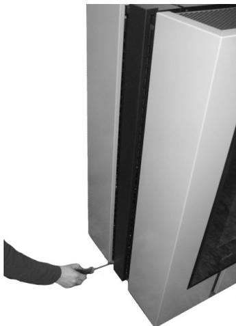
*Fig. 78 - Lösen der unteren Schrauben*
