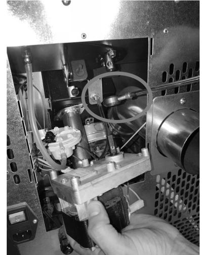
**Fig. 72 - Getriebemotor entfernen**
