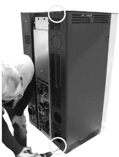
**Fig. 94 - Die hinteren Schrauben entfernen**
