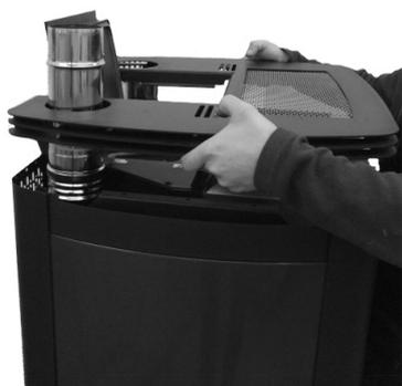
**Fig. 90 - Entfernen der Abdeckung**
