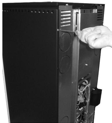
*Fig. 76 - Lösen der hinteren Schraube*
