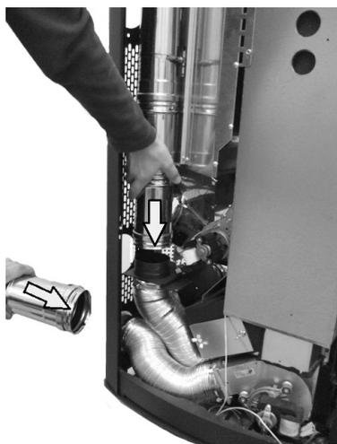
**Fig. 63 - Positionierung der Rohre für Kanalisierung**
