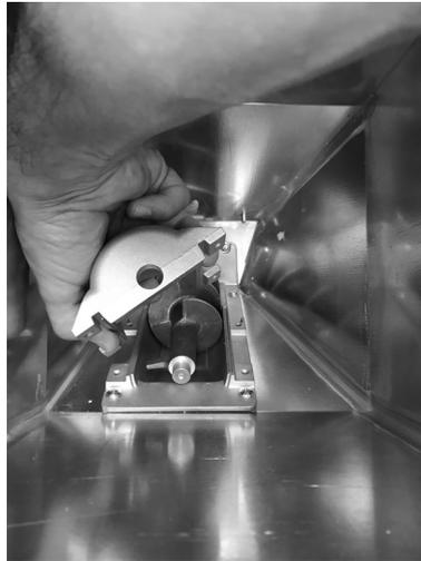
**Fig. 71 - Gehäuse entfernen**
