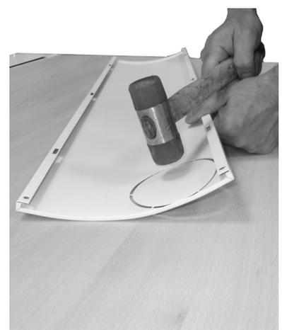
Fig. 38 - Öffnen Sie das Loch (Modell Sfera<sup>3</sup> Plus)
