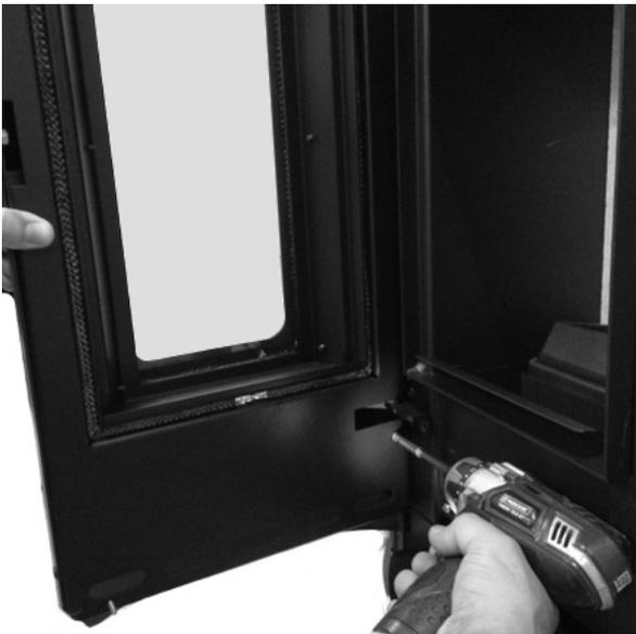
**Fig. 85 - Schraube lösen**
