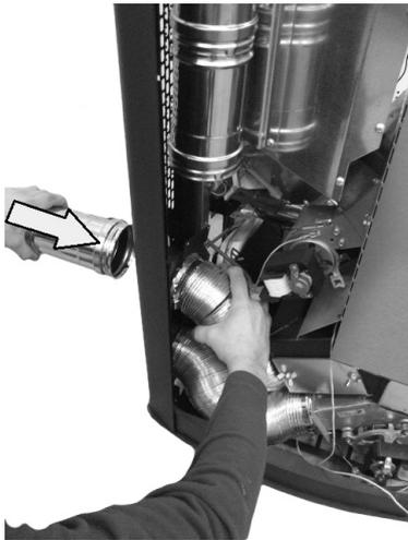
**Fig. 66 - Positionierung der Rohre für Kanalisierung**
