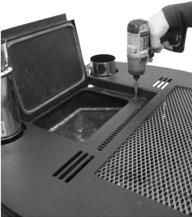
*Fig. 41 - Die oberen Schrauben entfernen*
