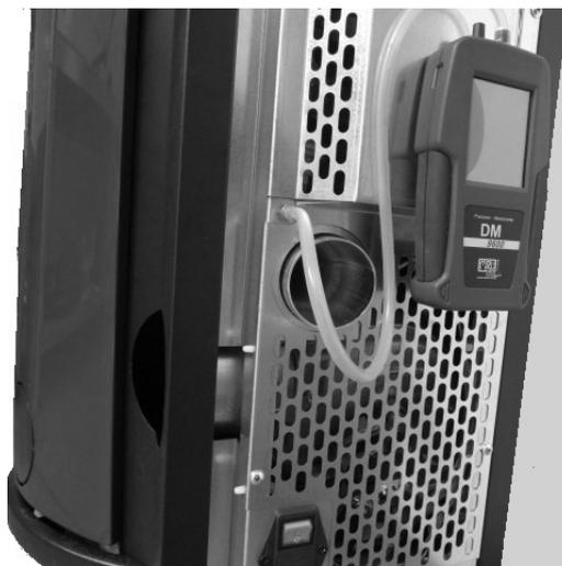
Fig. 55 - Anschluss des Digitaldruckwächters
