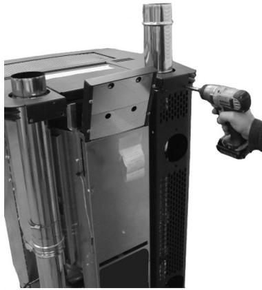
*Fig. 42 - Die Schrauben auf der Rückseite entfernen*
