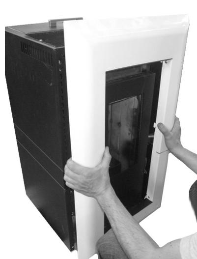
Fig. 25 - Positionierung Rahmen
