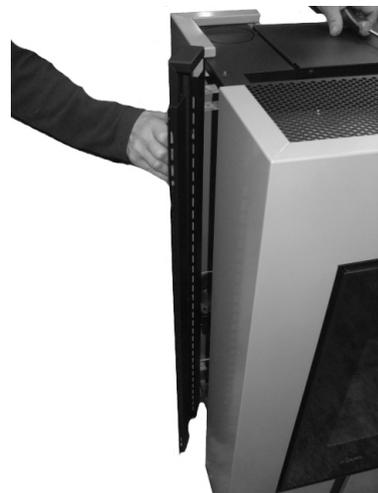
*Fig. 79 - Herausnehmen der mittleren Platte*
