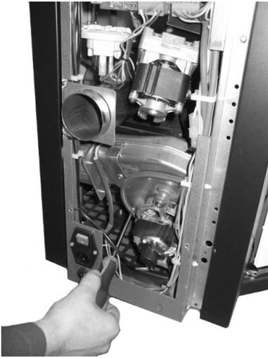
**Fig. 104 - Reinigung Rauchgasansauggerät:
