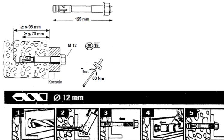
Bild 1: mit 12 mm Steinbohrer mind. 105 mm bohren.
