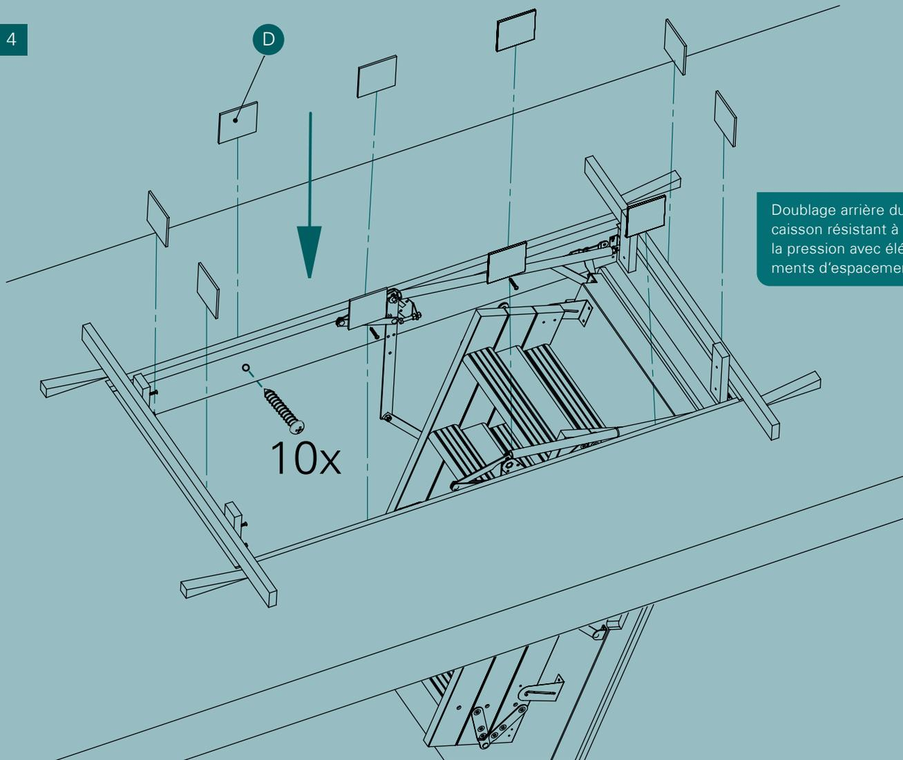
Doublage arrière du caisson résistant à la pression avec éléments d'espacement.
