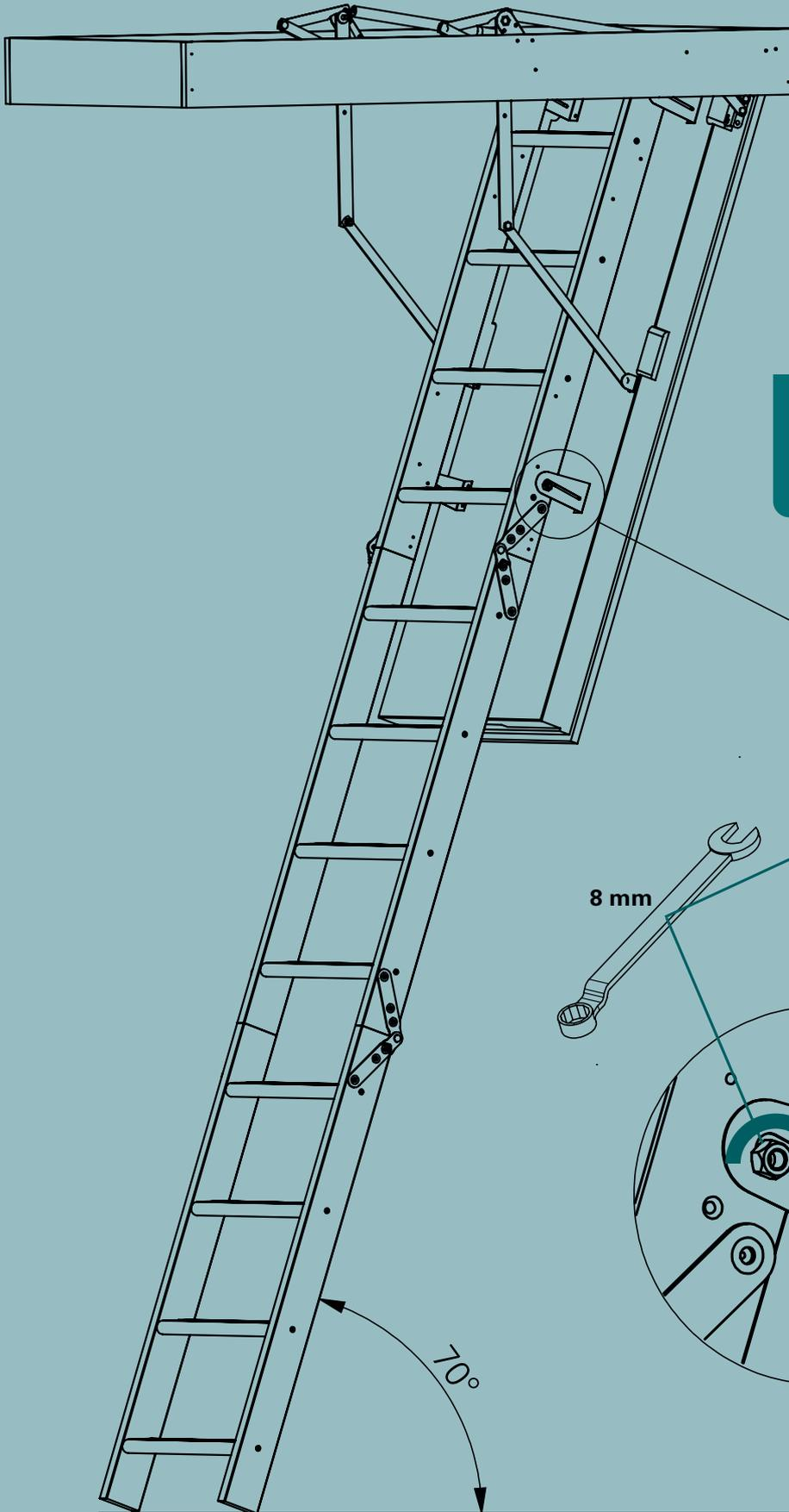
Passer l'escalier de la position de transport (en bas) à la position de service (en haut). Pour cela, desserrer l'écrou à l'aide d'une clé à fourche de 8 mm et resserrer une fois l'escalier relevé.
