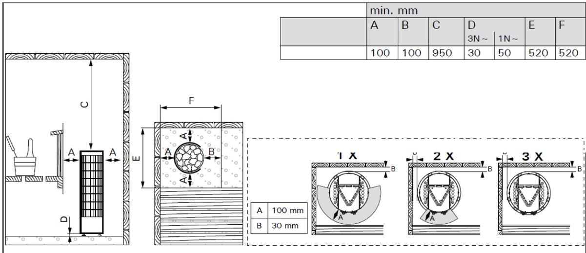
Abbildung 6. Sicherheitsmindestabstände (alle Abmessungen in Millimetern)
