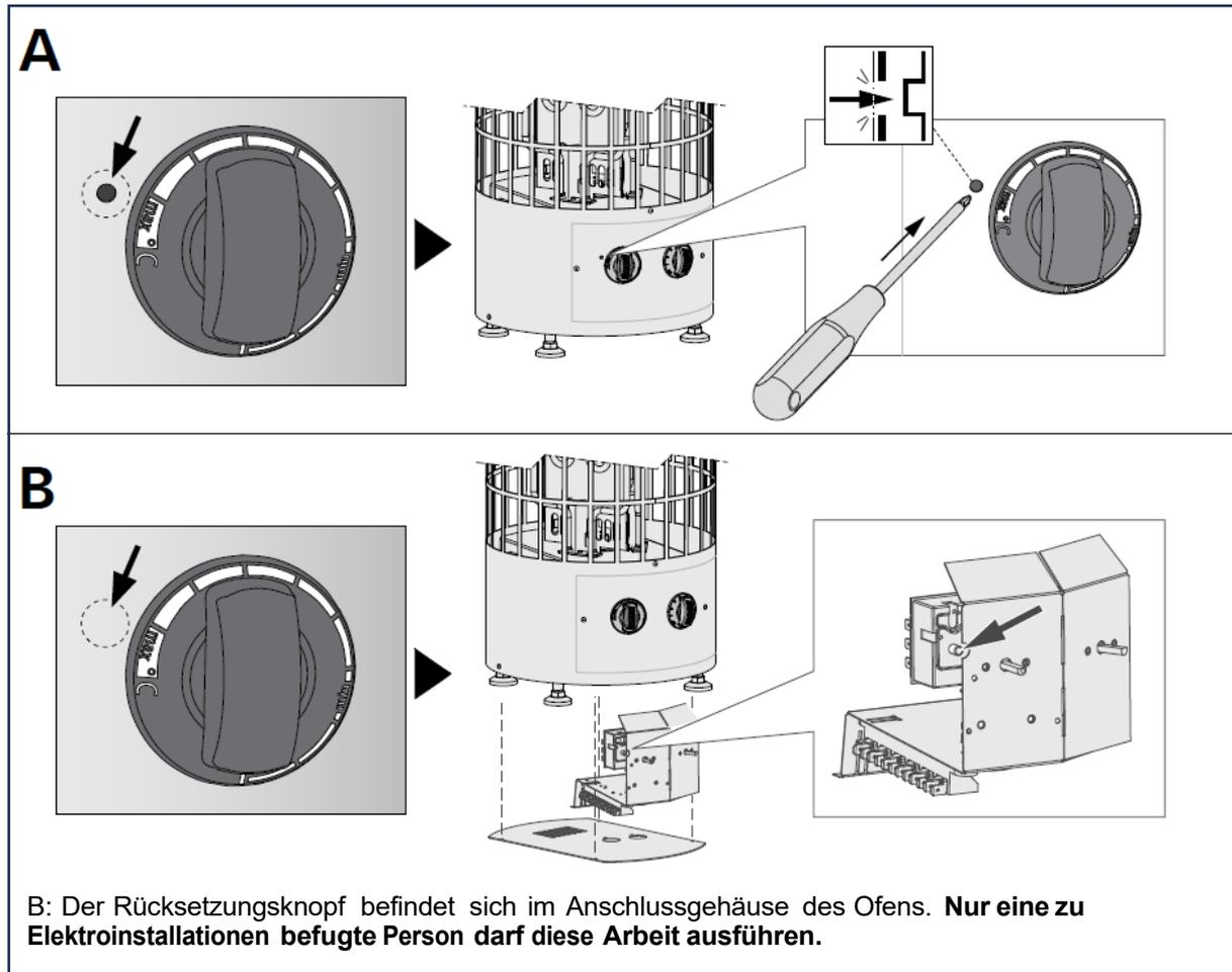
Abbildung 10. Rücksetzknopf des Überhitzungsschutzes
