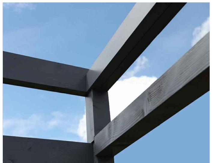
Placez maintenant la traverse de support des voliges sur le poteau d'angle de la façade, pré-percez et vissez-la de l'intérieur contre la panne sablière avec 6 vis C105-0050. Laissez aux extrémités un écart d'env. 5 cm.
