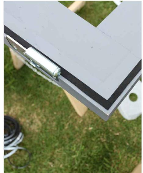
Collez maintenant le joint d'étanchéité de 9 mm (A109) sur le bord extérieur du côté externe de la porte en respectant un écartement de 3 mm par rapport au bord externe. Seulement sur le bord intérieur de la à détecteur, coller le ruban d'étanchéité (A109) à ras (distance 0cm). À la jonction des plaques au milieu veuillez utiliser le joint d'étanchéité A111.
