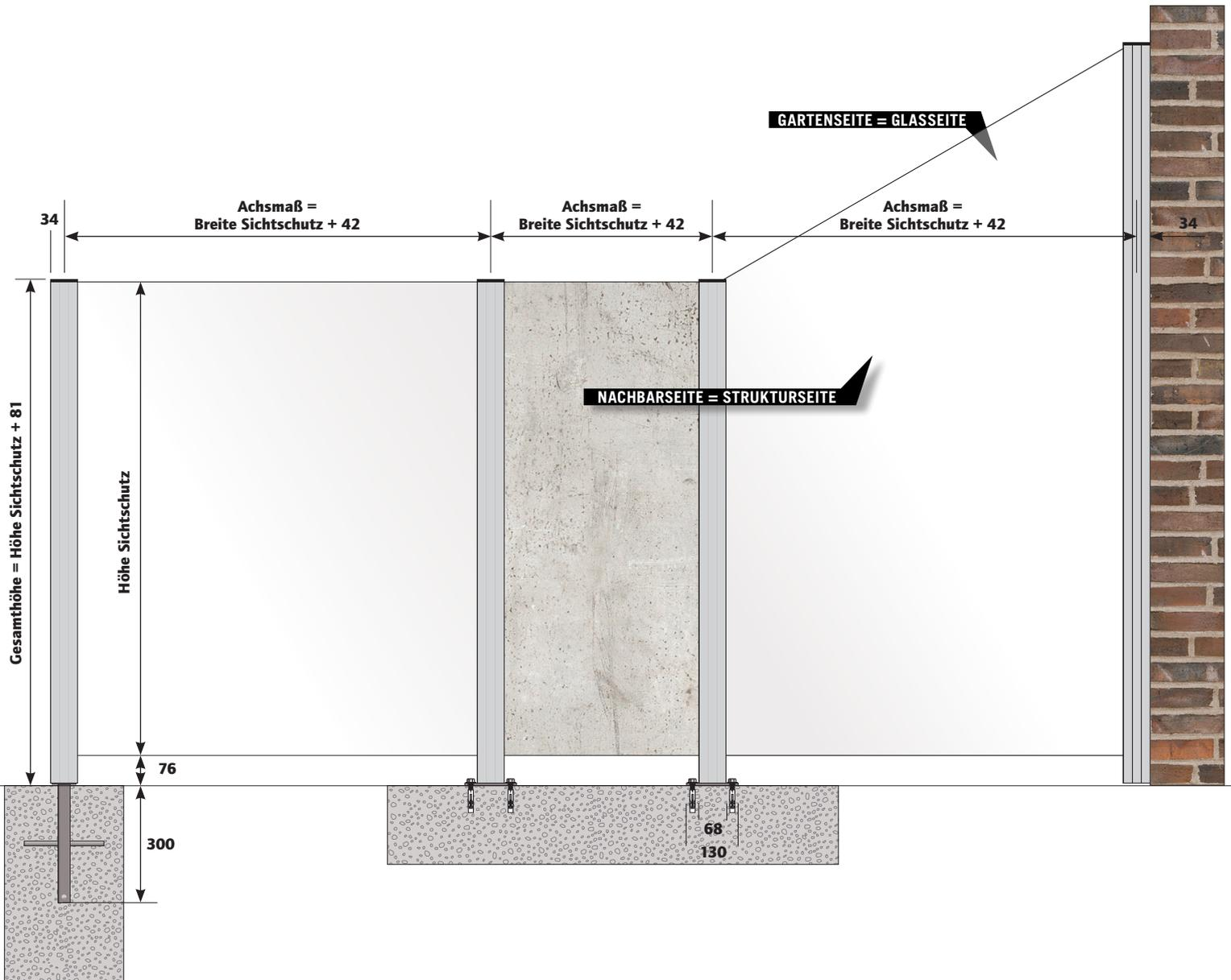
**1** Pfostenanker fachgerecht betonieren bzw. anschrauben
