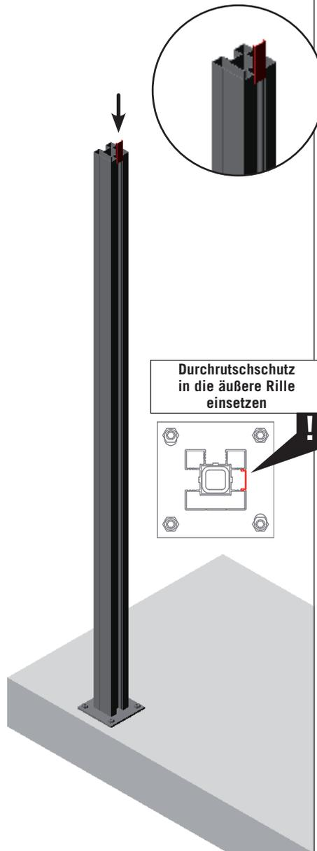
**4** Gummidichtung auf Durchrutschschutz montieren; Montageklötze positionieren
