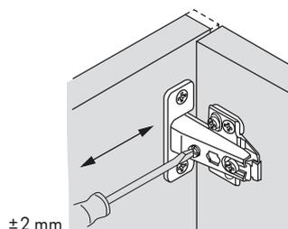
Alle Möbelscharniere können seitlich um  $\pm 2 \text{ mm}$  über eine Stellschraube im Bandarm verstellt werden.
