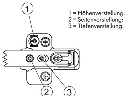
Alle Möbelscharniere können in Kombination mit Ihren Montageplatten dreidimensional verstellt werden. Einige Verstellungen können, je nach Ausführung der Montageplatte über Excenter vorgenommen werden. Dies erleichtert den Verstellvorgang erheblich.
