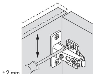
Alle Montageplatten können in der Höhe um  $\pm 2 \text{ mm}$  über ein Langloch, internes Verschieben oder über Excenter verstellt werden.
