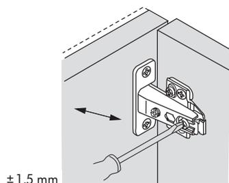
Alle Möbelscharniere können in der Tiefe um  $\pm 1,5 \text{ mm}$  über eine Fixierschraube im Bandarm verstellt werden. Je nach Ausführung kann auch an der Montageplatte diese Verstellung über einen Excenter vorgenommen werden.
