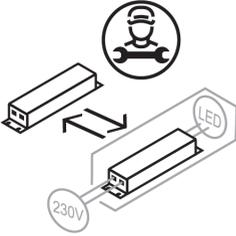
Das Vorschaltgerät kann von einer Elektrofachkraft ausgetauscht werden. Eine Anleitung zum Tausch des Vorschaltgerätes finden Sie auf unserer Website.
