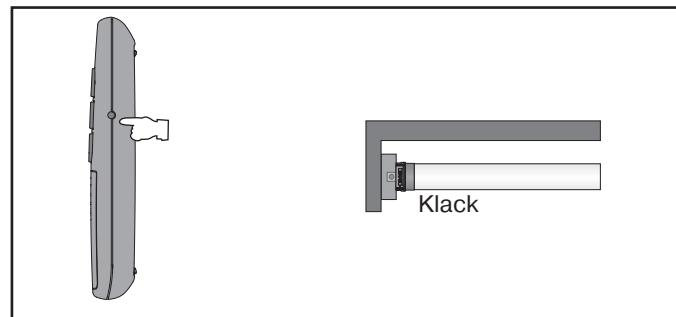
b)Drücken Sie nun die Einlerntaste des SC861, bis der Rohrantrieb 1x klackt.
