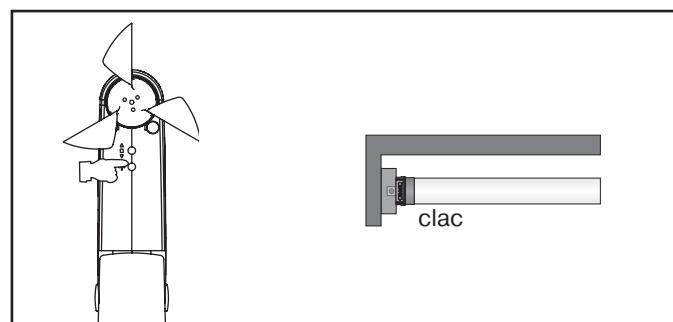
c)Appuyez maintenant une nouvelle fois sur la touche de programmation du SC861 à programmer jusqu'à ce que le moteur tubulaire claque 2 fois.
